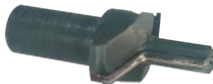
Naoštreno dijamantno profilno glodalo
