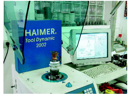
Elektroničko balansiranje alata nakon izrade ili oštrenja
