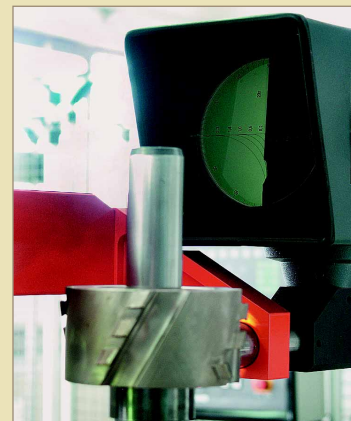
Na elektroničkom mjernom instrumentu traži se najniža točka zatupljenja oštrice te po njoj određuje visina izbrušenja dijamanтne pločice. Nakon oštrenja alat se na Presetu ponovo izmjeri
