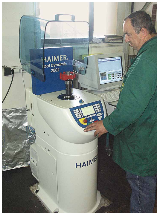
Balansiranje alata nakon svake reparacije ili nekoliko oštrenja
