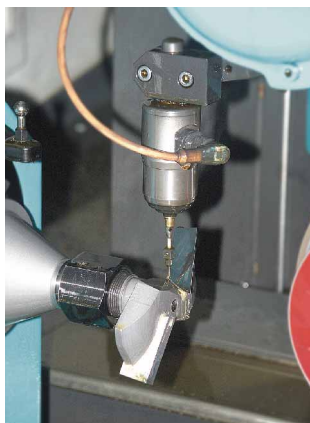
5-osni CNC za oštrenje i izradu glodala
