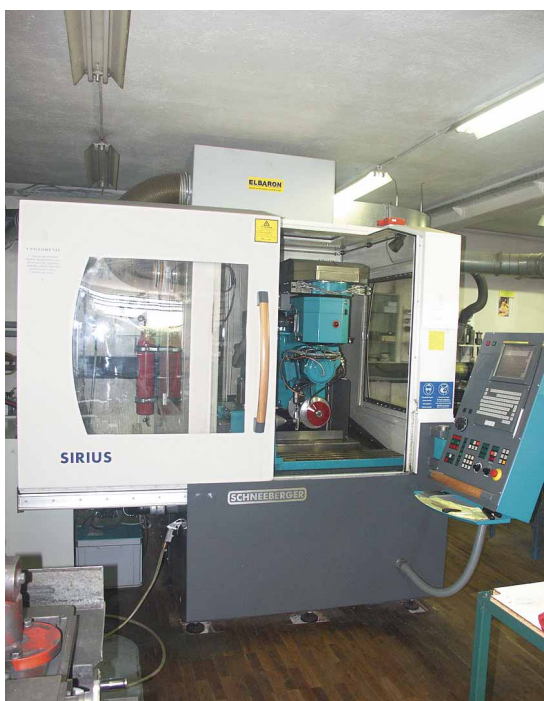
5-osni CNC za oštrenje i izradu glodala
